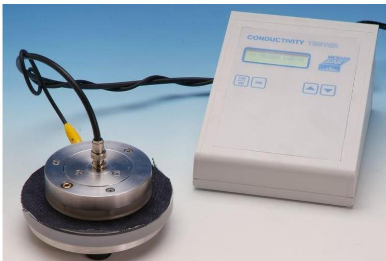
Apparecchio adatto per il controllo dell'elettricità statica presente sui tessuti di abbigliamento, tessuti protettivi, tessuti per calzature e pelle in genere. Range di misura  $10^5 - 10^{14}$  Ohm.
