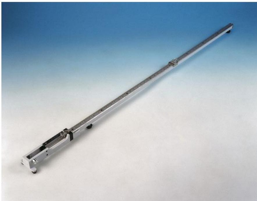
Strumento per il calcolo del crimp nei filati, causato dalle fasi di lavorazione in tessitura e maglieria. L'apparecchio determina con assoluta precisione la lunghezza di un tratto di filo, per cui dopo la pesatura è possibile determinarne il titolo.
