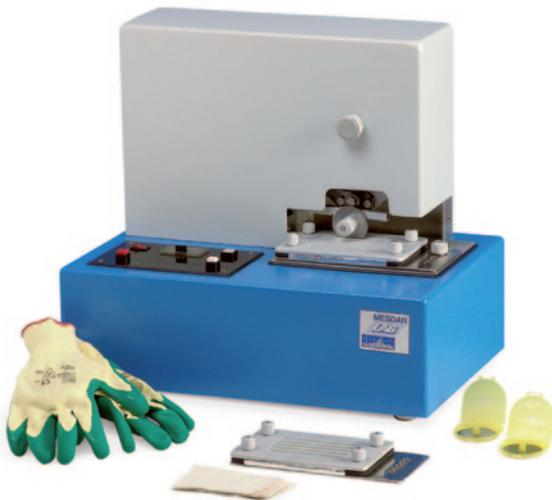
Strumento utilizzato per valutare la resistenza al taglio di indumenti di protezione.
