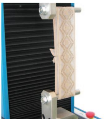
Morsetti meccanici per test loop di allungamento e recupero, secondo la norma ASTM D4964, **Cod. 2510.932**
