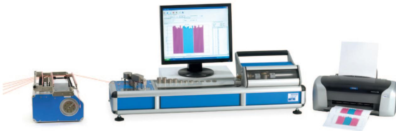
Torsiometro automatico gestito tramite software, per il controllo della torsione di ogni tratto di filo ad intervalli prestabiliti.
