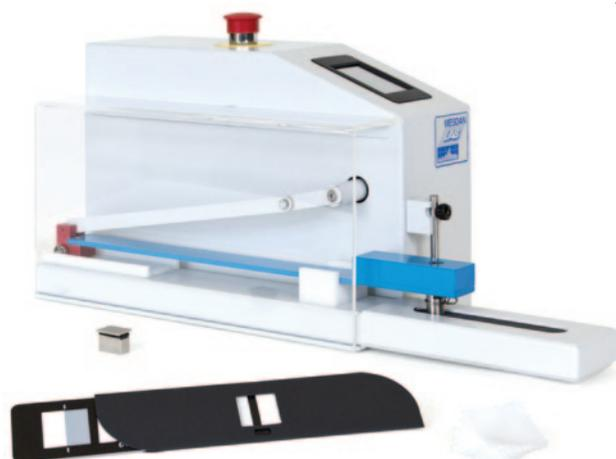
Strumento elettrico adatto per il controllo della solidità del colore allo sfregamento. Corredato di conta-cicli digitale. Completo di una caviglia cilindrica di sfregamento ( $\varnothing$  16 mm) e di una caviglia rettangolare da 19 x 25,4 mm, ciascuna dotata di un apposito peso per raggiungere i 9N
