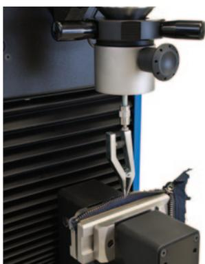
Esempio di morsetto superiore del kit per test su cerniere, conforme alla norma ASTM D2061, **Cod. 2510.157**
