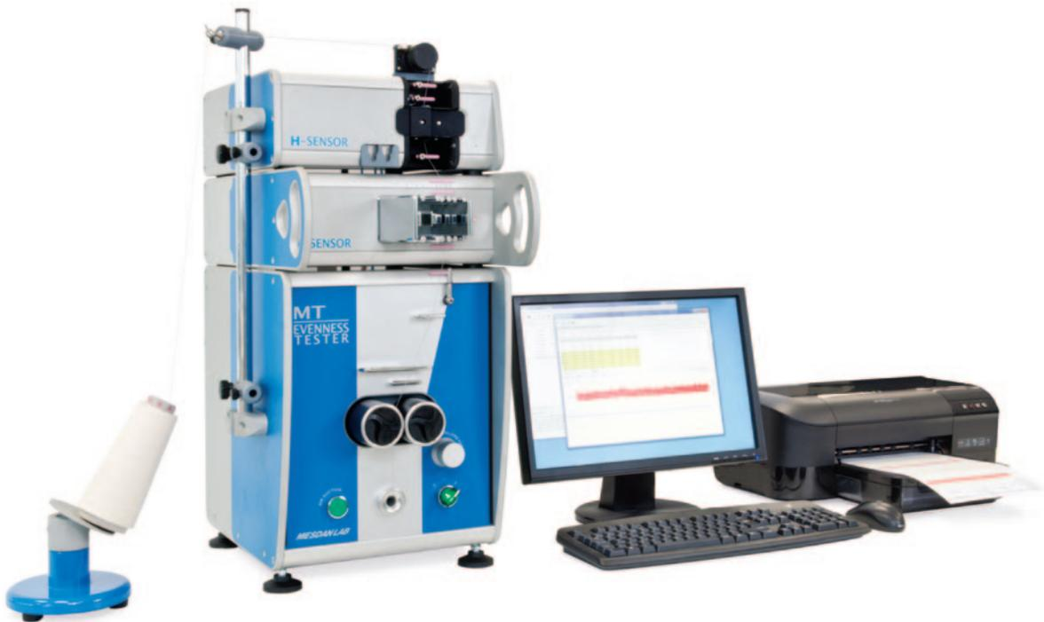
Strumento per il controllo della regolarità dei nastri, stoppini e filati formati da fibre sia naturali che sintetiche/artificiali in fiocco. Utilizzando dei sensori capacitivi di elevata precisione, l'apparecchio è in grado di rilevare, analizzare, calcolare, visualizzare e stampare i seguenti dati:
