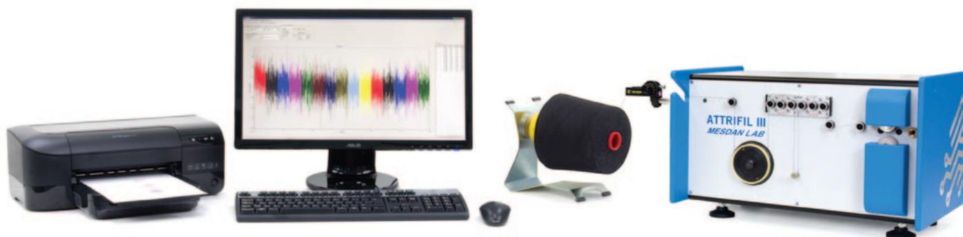
Sistema computerizzato per la misurazione automatica del coefficiente di attrito dei filati.
