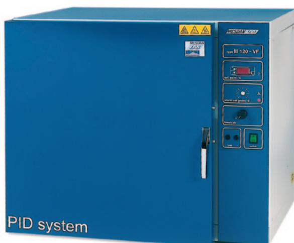
Stufa ad alta tecnologia, adatta per il controllo del crimp dei filati e della stabilità dimensionale dei tessuti sottoposti ad aria calda. Indicata per la pulizia a caldo delle filiere meccaniche, nonché per asciugare e/o riscaldare qualsiasi tipo di materiale tessile. Completa di regolatore digitale di temperatura e due ripiani grigliati in acciaio inox.
