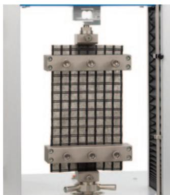
Morsetti meccanici per non-woven e geotessili, con ganasce in gomma da 200 mm, **Cod. 2515.142**
