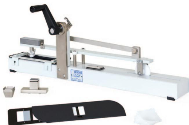
Strumento adatto per il controllo della solidità del colore allo sfregamento. Corredato di conta-cicli digitale. Completo di una caviglia cilindrica di sfregamento ( $\varnothing$  16 mm) e di una caviglia rettangolare da 19 x 25,4 mm, ciascuna dotata di un apposito peso per raggiungere i 9N.
