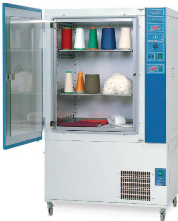
Strumento da laboratorio per il condizionamento di tutti i prodotti tessili (come fibre grezze, filati in rocche e matasse, tessuti e capi finiti in genere) a temperatura e umidità costanti, in conformità a quanto previsto dalle norme ISO ed ASTM.
