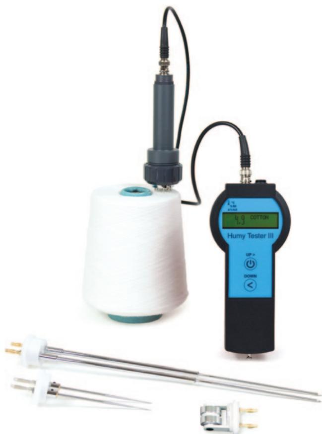
Strumento elettronico portatile per la rilevazione istantanea della percentuale di umidità nei tessuti.
