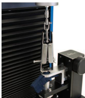
Morsetto per bottoni, ecc.: Superiore (**Cod. 2510.155**) e supporto inferiore (**Cod. 2510.154**) da montare sul morsetto inferiore (**Cod. 2510.150**)
