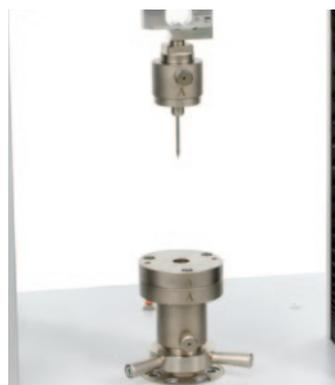
Kit per test di perforazione (secondo la norma EN 388), **Cod. 2510.681**
