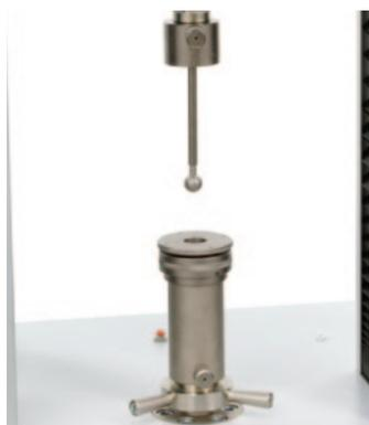
Kit per test di perforazione (secondo la norma ASTM D6797, ISO 9073-5), **Cod. 2512E.799**
