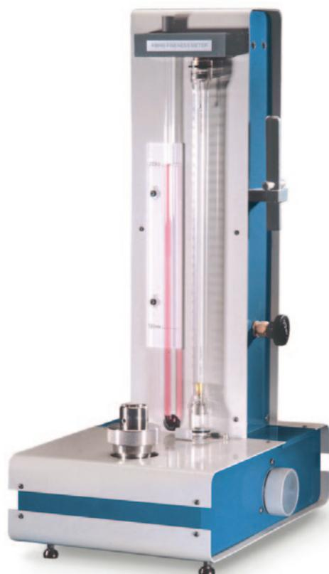
Per il controllo della finezza delle fibre di cotone.
