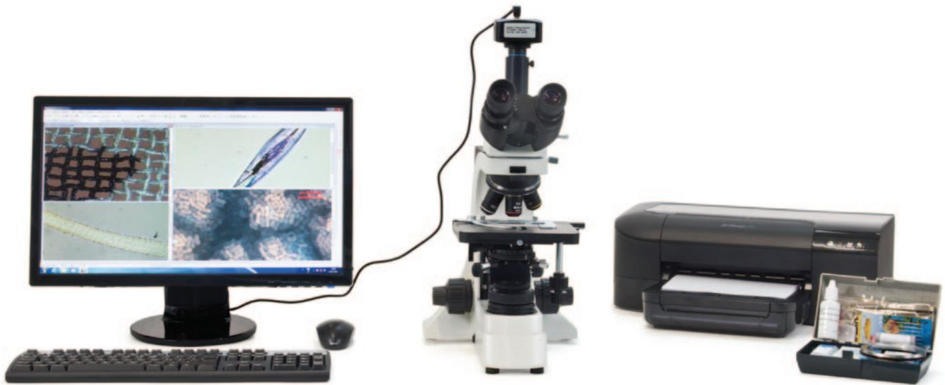
Sistema computerizzato ad alta definizione per l'analisi di fibre e filati.
