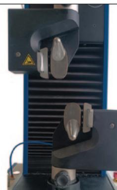
Morsetti pneumatici ("Bollard") per filati ad alta tenacità, **Cod. 2512E.760**
