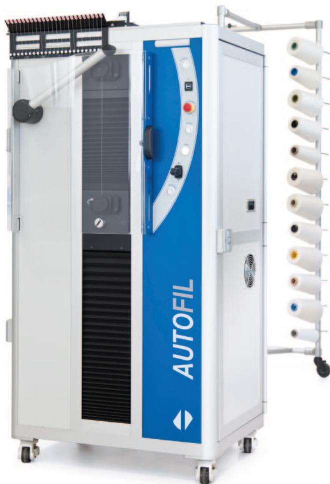
Dinamometro completamente automatico, a 24 posizioni. Rappresenta la punta di diamante della nuova generazione dei dinamometri Mesdan.
